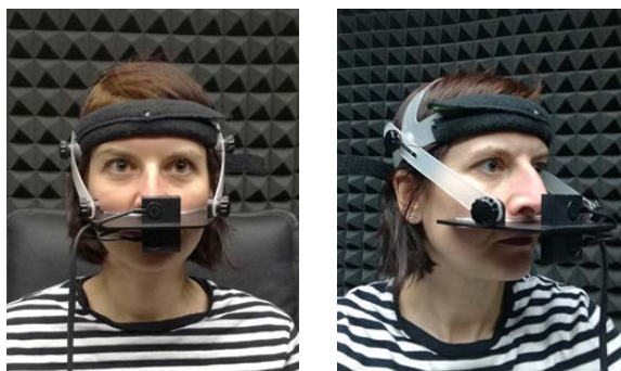
Rycina 2. Zastosowanie urządzenia Nasometer II, model 6450, Pentax Medical do badania rezonansu nosowego
